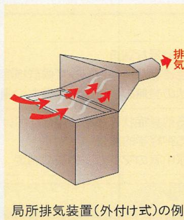
局所排気装置(外付け式)の例
